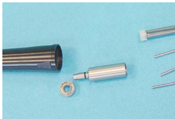
Schritt 5: Die Welle mit dem Lager fällt nun heraus.
