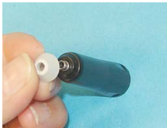
Schritt 7: Dann wird die Staubkappe wieder aufgesteckt.
